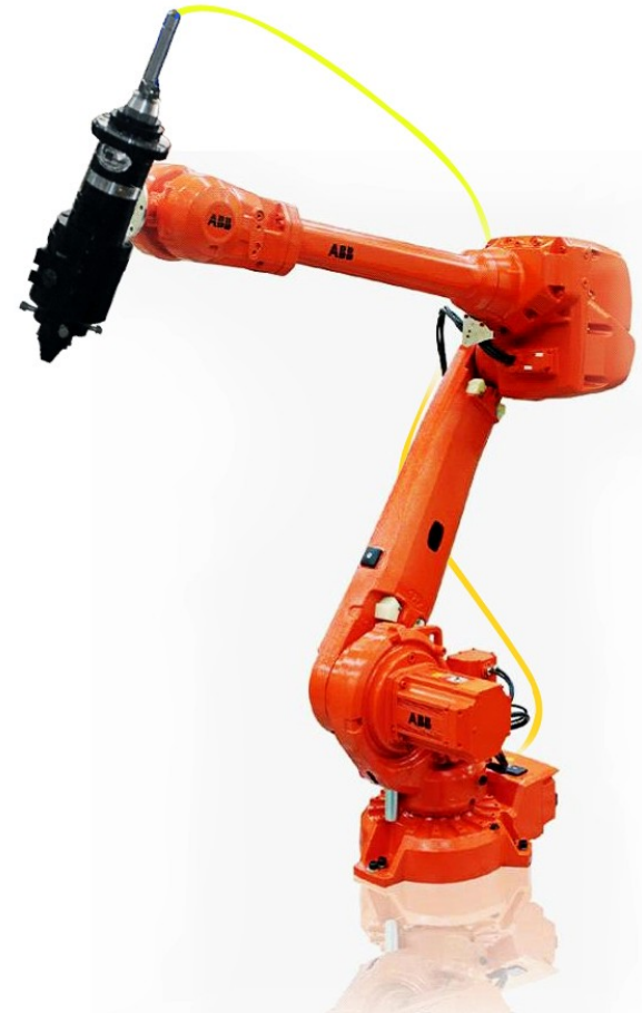
obr. 2: robotická ruka s laserem
