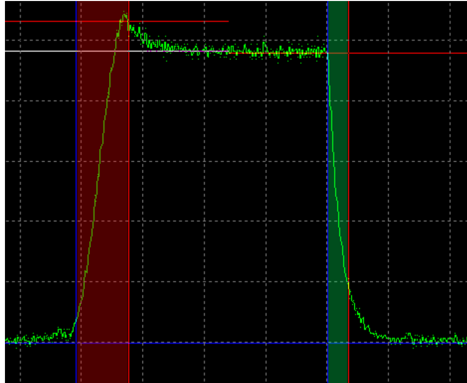
obr. 2: časový průběh natáčení krystalů při použití technologie OverDrive
